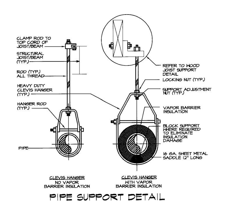
I) ALL HANGERS FOR COPPER PIPING SHALL BE COPPER COATED.
