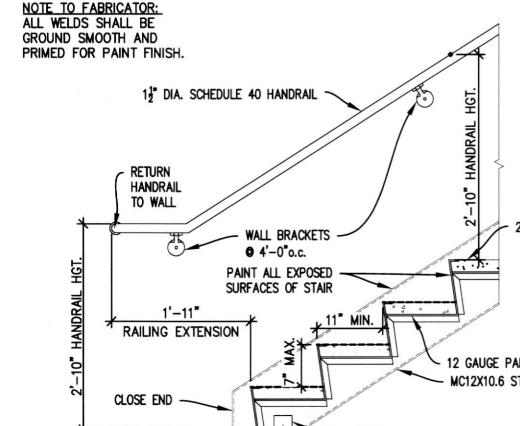
4 TYPICAL WALL HANDRAIL DETAIL
